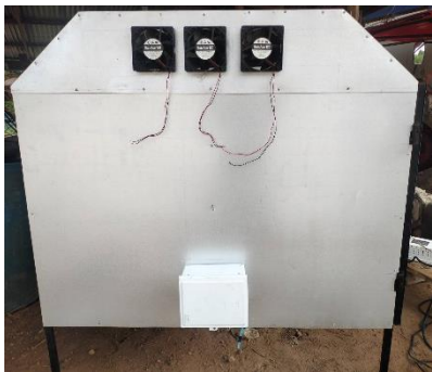
ภาพที่ 6 การติดตั้งพัดลมระบายความชื้น
